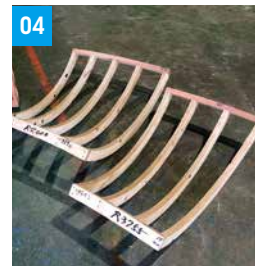
構造物の形状の骨組みを製作
